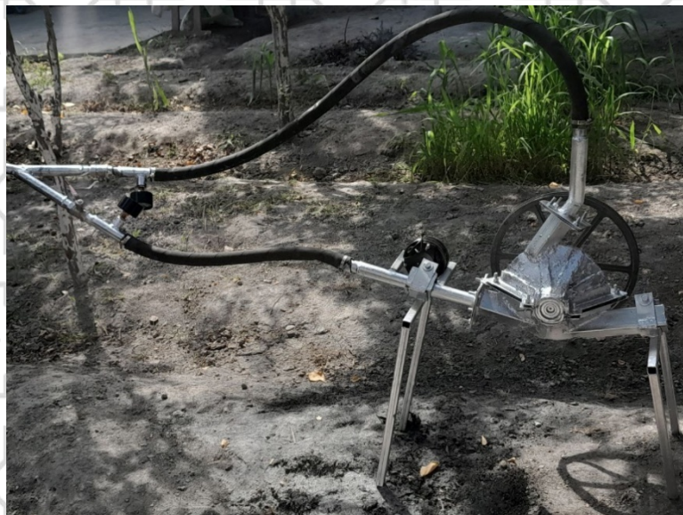
7-rasm. Ikkita ta'minot quvuriga ega konstruktsiya. Suv barabanning har ikki tomoniga bir xil ta'sir qiladi.
